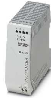
Fuente de alimentación, 1 AC, 24 DC, 60 W NEC clase 2
