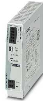
Fuente aliment., 1 AC, 24 V DC, 3 A NEC Class 2
